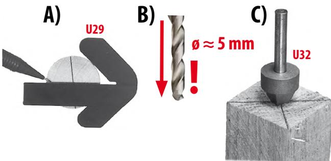
A) Ermitteln des Mittelpunktes runder Werkstücke B) **Vorbohren!** C) U32 mit einem Hammer in den Holzmittelpunkt schlagen (ca. 5 mm).
