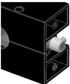
**Cambio de la hoja de sierra:** abra tornillo Ub, reemplazar hoja, fijar Ub o Quitar soporte de la sierra, apartar tornillo Ub completamente, quitar Ua, limpiar el botador (Y), eliminar los fragmentos de la hoja (X), montar Ua, reemplazar hoja, fijar Ub.
